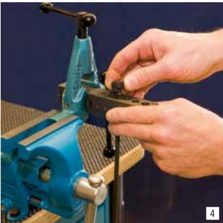
Stecken Sie das gleitfähig gemachte Druckstück auf das Rohr und setzen Sie das Vorgabestück mit der Öffnung nach unten darauf. Dann schieben Sie die Spannbacke soweit in das Gerät, bis das Rohrende mit dem Druck- und Vorgabestück unter der Druckspindel liegt.
