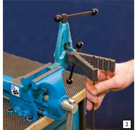
Öffnen Sie die Spannbacke und legen das zu bördelnde Rohr in die entsprechende Aufnahmebohrung. Das Rohr oben 6 mm überstehen lassen und die Spannbacke schließen.
