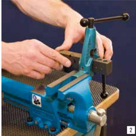
Schieben Sie dann die Spannbacke, mit der Seite „F“ nach oben, bis zum Anschlag in das Gerät.
