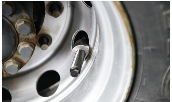
Drehen Sie jetzt am Spindeltrieb SW17 bis sich die äußere von der inneren Felge löst.
