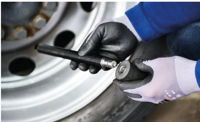
Wählen Sie je nach Bauform der Felge eines der beiden Druckstücke (Wiederlager) aus und schrauben es auf die Spindel.
