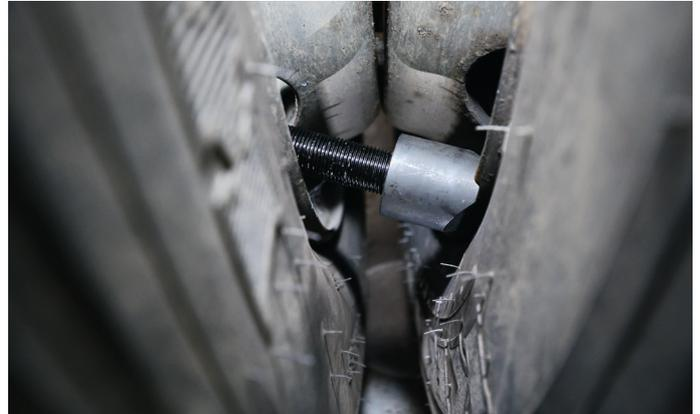
Betätigen Sie als nächstes die Spindel solange bis das Druckstück (Wiederlager) an der Innenseite des Felgenloches anliegt.
